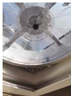
Die Dachlüfter sind mit einem leistungsstarken Ventilator ausgestattet und können auch bei Regen und Sturm geöffnet werden. Gesteuert werden die Lüfter über die Tasten am Lüfter selbst oder mit der Mitgelieferten IR-Fernbedienung
