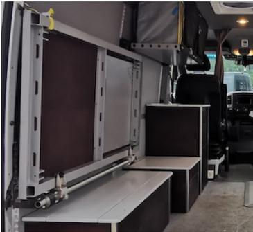
Die leichte Aluminiumkonstruktion ermöglicht einen vielseitigen Einsatz. Es ist höhenverstellbar und lässt sich auch als Stockbettvariante montieren. Der Freie Platz auf der anderen Seite kann für z.B. Fahrräder oder Motorräder genutzt werden. Ebenso kann das Bett schnell seitlich angeklappt werden, sodass der Raum als Stauraum für grössere Ladungsobjekte genutzt werden kann. Die Länge kann von 140 - 200 cm verstellt werden.
