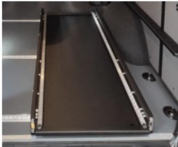
Der Schwerlastauszug ist bis 150kg belastbar und ermöglicht Ladung bequem von hinten zu verstauen. Besonderes Augenmerk haben wir auf die Auswahl hochwertiger Schwerlastauszüge gelegt, um ein klapperfreies und möglichst leichtes System herstellen zu können. Die seitlich montierten Airlineschienen, erweisen sich in der Praxis als super hilfreich, um Ladungen schnell sichern zu können. Gerne werden hierzu die Frontrunner Gummispanngurte verwendet.
