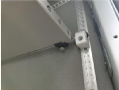
Das ESSENTIAL VANS Regal ist derzeit unsere leichteste Lösung, um Ladung, oder in Kombination mit den optionalen ESSENTIAL VANS Taschen, zu verstauen. Das Regal lässt sich seitlich hochklappen und über Rändelschrauben horizontal positionieren, bzw. auch fixieren. Das Regal wird mit EV-Gurten an der Vorderseite abgehängt. Optional können auch Reeb schnüre verwendet werden.
