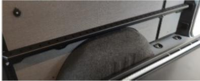
Winkel Leiste aus Stahl wird montiert zwischen vertikalen Airlineschienen oberhalb der Radkästen im Laderaum. Darauf können die Laderaum Ebenen montiert werden. Farbe: schwarz pulverbeschichtet
