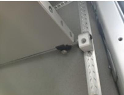
Das ESSENTIAL VANS Regal ist derzeit unsere leichteste Lösung, um Ladung, oder in Kombination mit den optionalen ESSENTIAL VANS Taschen, zu verstauen. Das Regal lässt sich seitlich hochklappen und über Rändelschrauben horizontal positionieren, bzw. auch fixieren. Das Regal wird mit EV-Gurten an der Vorderseite abgehängt. Optional können auch Reeb schnüre verwendet werden.
